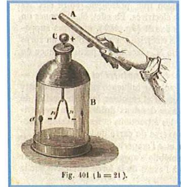
L'électroscope est un instrument scientifique qui permet de savoir si un corps est chargé ou non en électricité statique. Les p'tits génies frottent divers objets sur leur pull et leur cheveux puis l'approchent, sans le toucher, du sommet de l'électroscope.
